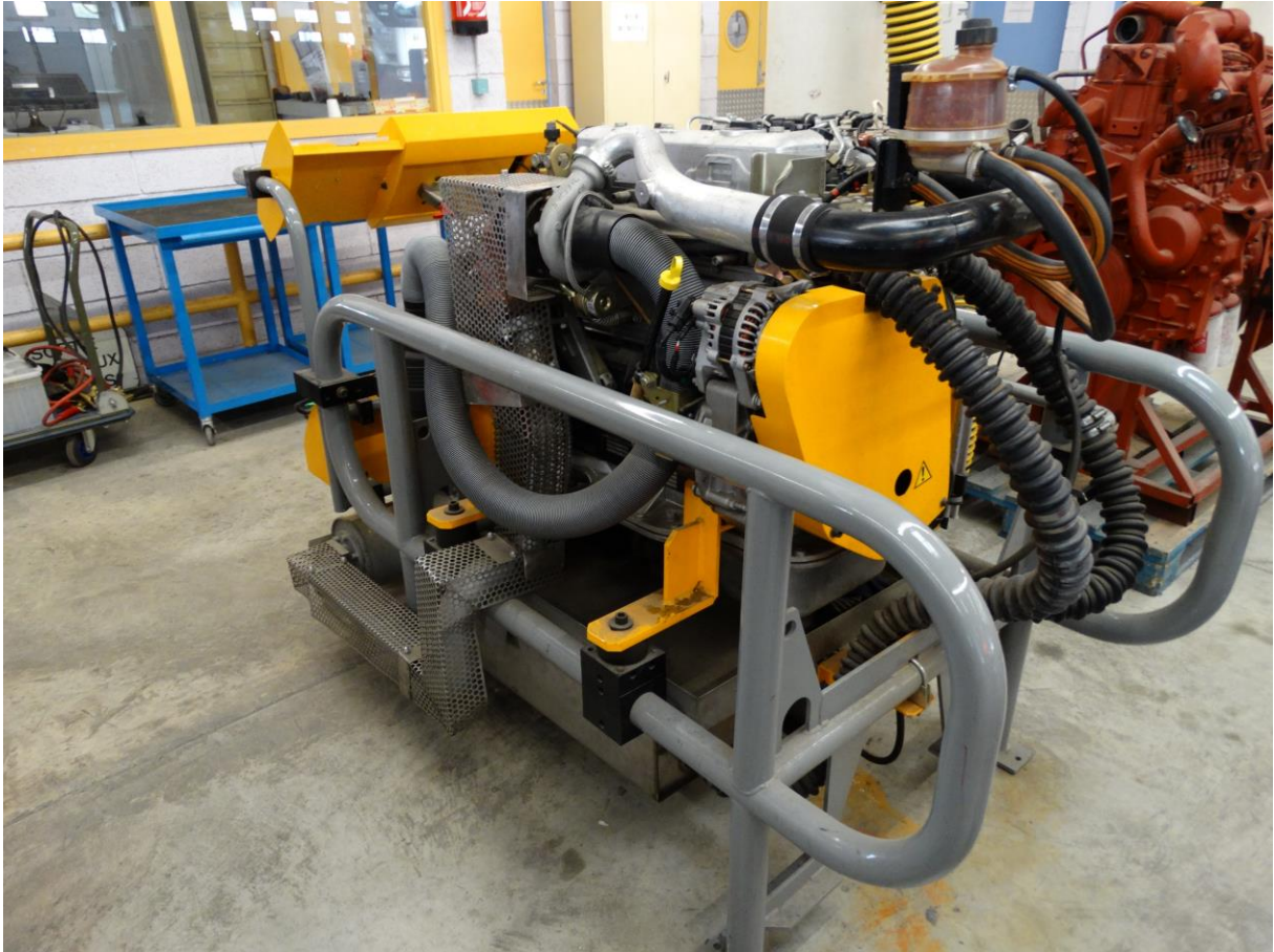
Banc d'essai moteur
